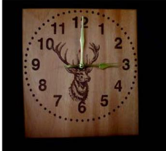
Le bois utilisé doit être découpé en fonction de l'objet à réaliser puis raboté et poncé. Ensuite, l'artisan réalise différents modèles de dessins et de motifs qu'il souhaite graver. Puis, il prépare sa machine et grave son objet.
